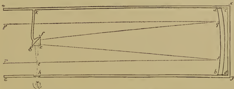
Abb. 65. Newtons schematische Zeichnung seines Spiegelteleskops.
